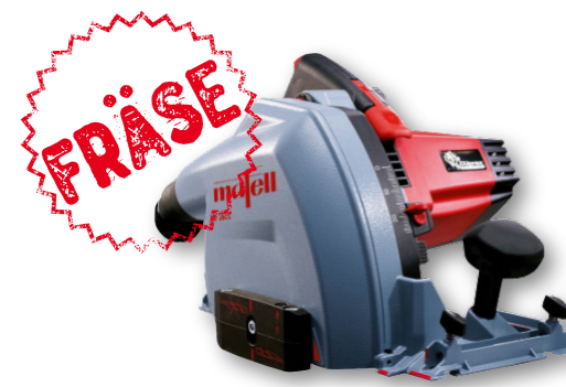
Multifräse MF26cc AF-MAX mit Aluverbundfräser 90° MF-AF, mit Sägeblatt 120x1,8x20mm Z40 FZ/TR im T-MAX zum Herstellen von Umkantungen und MTS Abschlüssen Art. Nr. 464600
